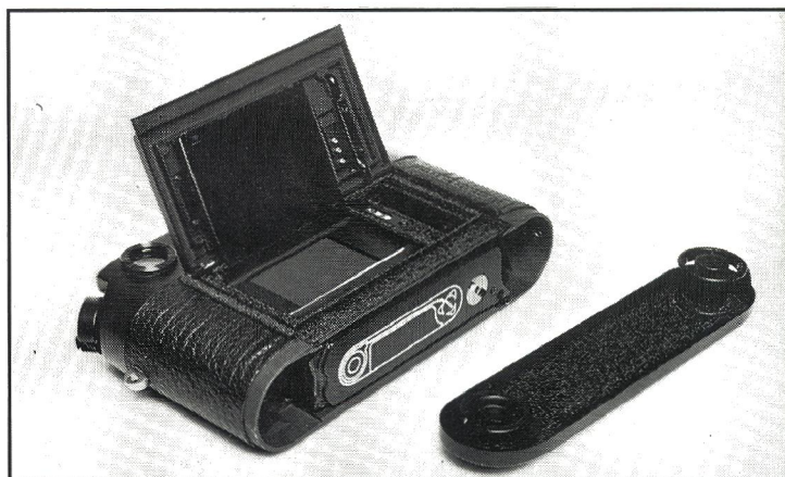
Kamerahuset er en robust, helstøbt konstruktion. Derfor lægges filmen i fra bunden, hvilket er lidt akavet i starten. Men når man først har lært det, så er det faktisk en uhyre nem form for filmilægning.
